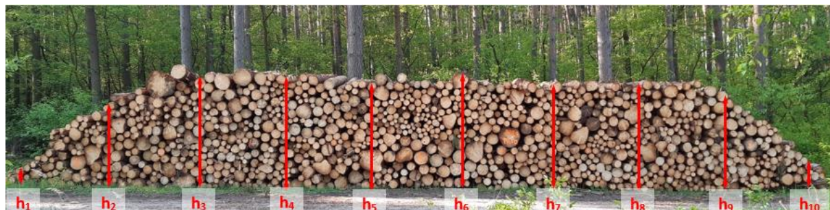
Ryc. 12. Pomiar wysokości stosu. Na czoło stosu naniesiono siatkę pomiarową, w której odległości pomiędzy pomiarami wynoszą 2 m
