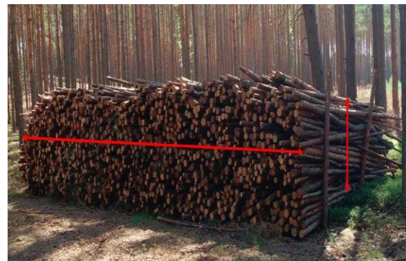
Ryc. 16. Pomiar przeciętnej szerokości w stosie S3A i M1 zabezpieczonym palikami. Pomiar wysokości w połowie długości
